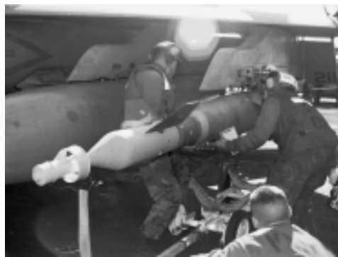
Рис. 2. Подвеска УАБ GBU-16 на истребитель-штурмовик F/A-18 «Хорнет»
