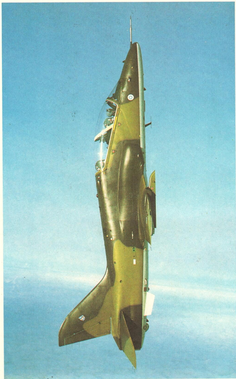
ЛЕГКИЙ ШТУРМОВИК «ХОК» МК51 ВВС ФИНЛЯНДИИ. Основные характеристики самолета: экипаж два человека; максимальная взлетная масса 7350 кг (пустого — 3750 кг), максимальная скорость полета у земли 1017 км/ч, практический потолок 14 170 м, радиус действия до 1500 км (в зависимости от боевой нагрузки и профиля полета); силовая установка — турбовентиляторный двигатель «Адур-851» максимальной тягой 2423 кгс. Вооружение: 30-мм пушка «Аден» Mk4 (боезапас 120 снарядов), бомбы (максимальная боевая нагрузка до 3000 кг). Размеры самолета: длина 11,17 м, высота 3 м, размах крыла 9,4 м, площадь крыла 16,7 м 2 .
