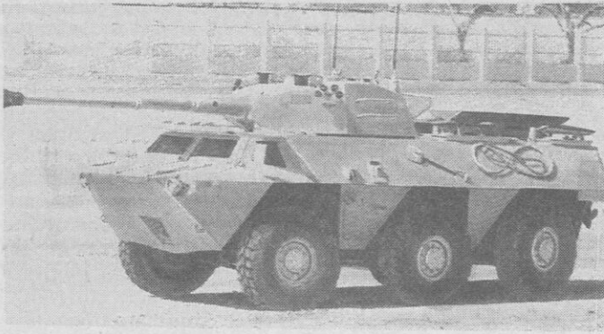
Рис. 2. Бронетранспортер «Дера Аль-Джазира-2» собственного производства (6×6) с 90-мм пушкой
