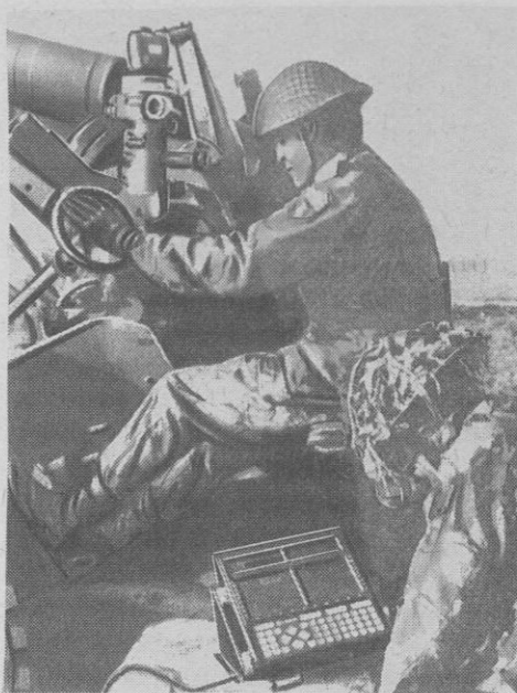
Рис. 5. Блок отображения установочных данных в переносном варианте, используемый командиром орудия
