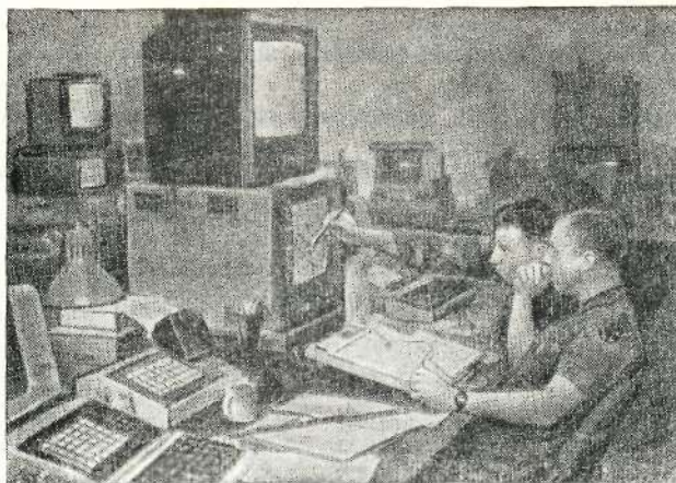
Рис. 2. Наблюдение за ходом учения (на экране верхнего дисплея ведется контроль записи действий подразделений на видеоманитофон)
