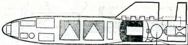
Рис. 3. Конструктивно-компоновочная схема ПТУР с боевой частью бокового боя, разрабатываемая в рамках программы создания легкого европейского ПТРК третьего поколения
