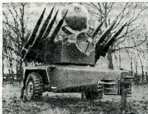
Опытный образец английского ЗРК малой дальности «Рапира-2000» (слева — пусковая установка с аппаратурой наведения ракет, справа — РЛС «Блайндфайр-2000»)
