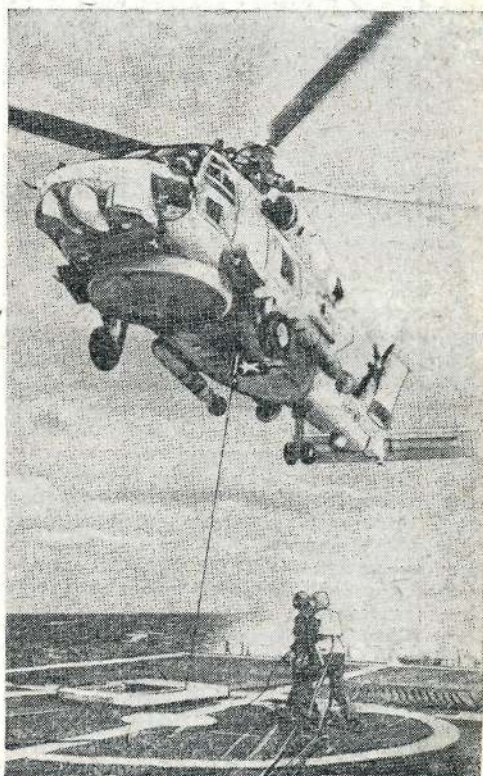
Рис. 2. Посадка вертолета на палубу корабля с помощью системы RAST
