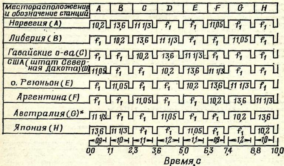
Рис. 6. Диаграмма форм сигналов системы «Омега»: f_1 — собственная частота (своя у каждой станции); (G)* — временно заменена станцией на о. Тринидад
