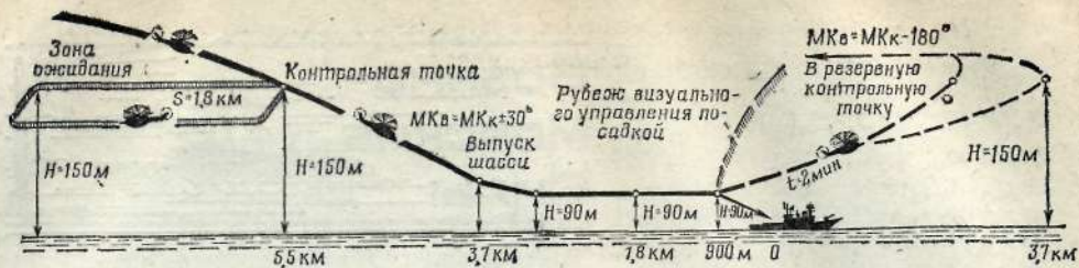
Рис. 1. Схема захода вертолета на посадку на палубу корабля, оборудованного радионавигационной системой ТАКАН
