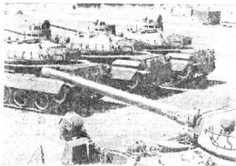
Рис. 1. 105-мм пушка танков AMX-30 Фото из журнала «Арме д'оурдюан»
