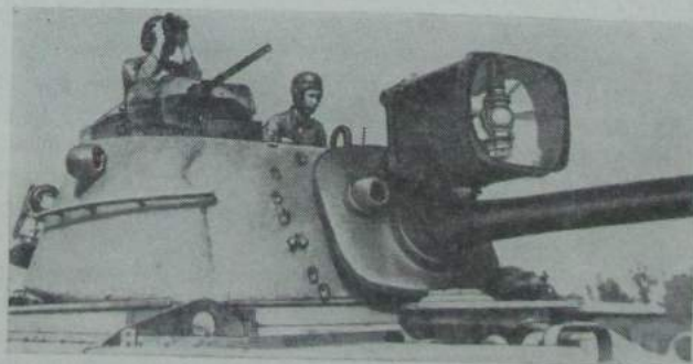
Рис. 4. Ксеноновый прожектор, устанавливаемый на танке М60.
