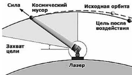
Рис. 3. Схема применения мощного наземного лазера для изменения орбиты объекта космического мусора (рисунок взят из интернета http://att-vesti.neva.ru/J31—2 . НТМ)
