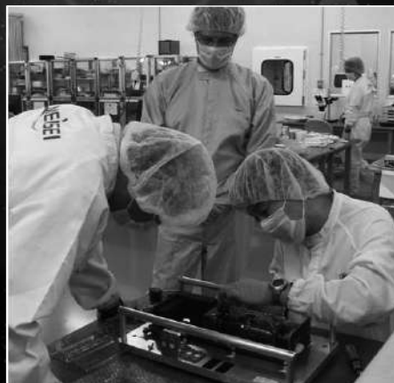
Входной контроль сканирующего узла российской-японской камеры MSASI
