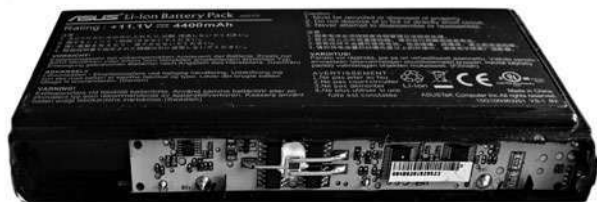
Аккумулятор с контроллером
