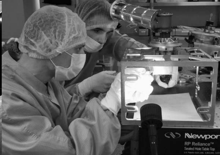
Настройка поворотного узла спектрометра ФЕБУС в ИКИРАН
