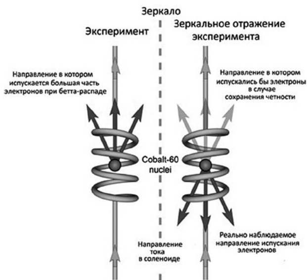
Схема эксперимента Ву (слева) и его зеркальное отражение (справа). Магнитное поле внутри соленоида слева направлено вниз, справа — вверх
