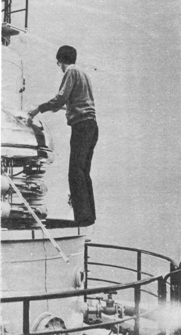
Для исследования новых металлов необходима сложная аппаратура. На фото 6, 7, 8 — наладка электронного микроскопа, кратностью увеличения до полумиллиона. Фото 9 — установка для испытания прочности материала на разрыв.
