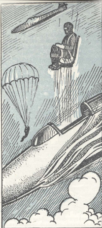
Покинуть скоростной самолет, в случае необходимости, летчику помогает катапульта, которая выбрасывает его вместе с сиденьем.
