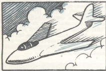
Крыльям скоростного самолета придают стреловидную форму, отгибая их назад. Передняя кромка такого крыла встречает поток воздуха под острым углом, и сопротивление воздуха уменьшается.
