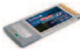
Беспроводной адаптер D-Link, работающий с тремя протоколами 802.11abg
