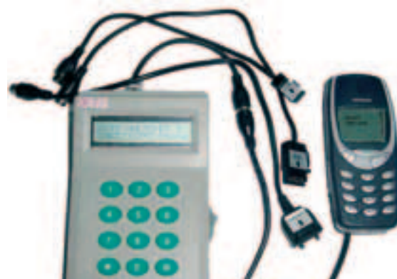
Устройство фирмы INSTORESA для изменения идентификационной информации сотового телефона
