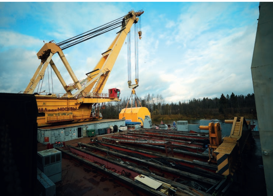
Для транспортировки саркофага со сверхпроводящей катушкой внутри использовался самый мощный в мире мобильный портовый кран
