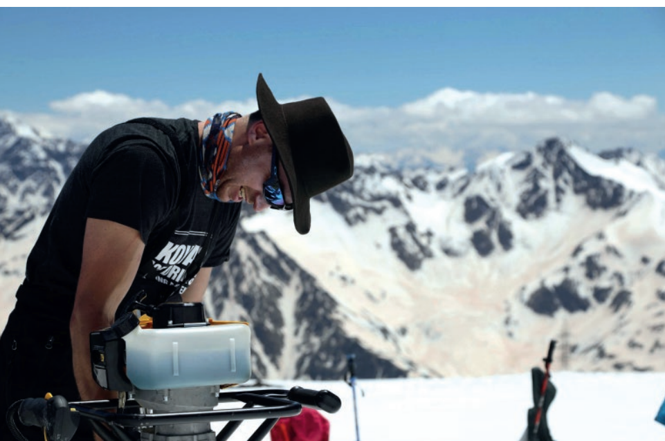
Установка абляционных реек на леднике Гарабаши. Фото: Сара Дель Бен.
