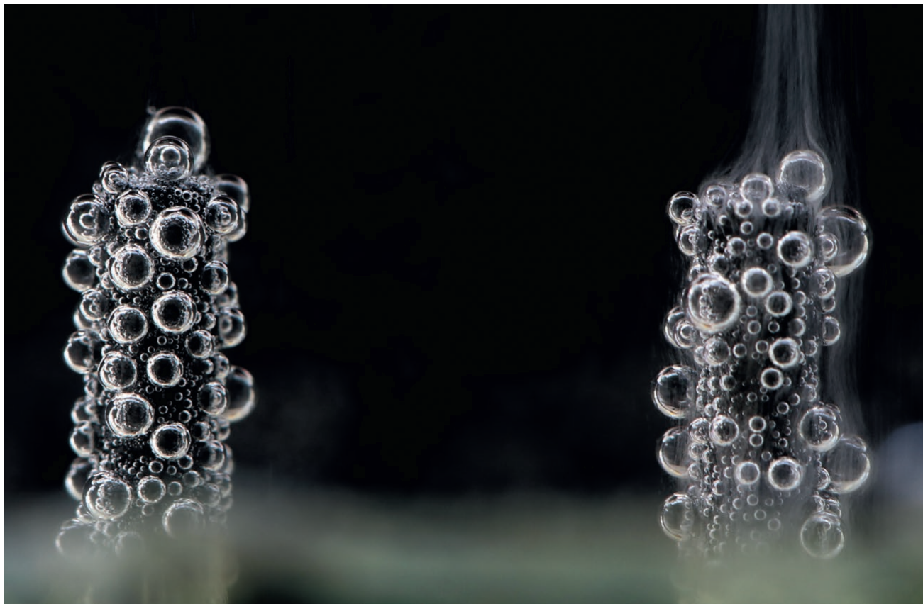
Электроды внутри электролизера расщепляют молекулы воды на кислород (слева) и водород (справа); высота электродов — 1 см
