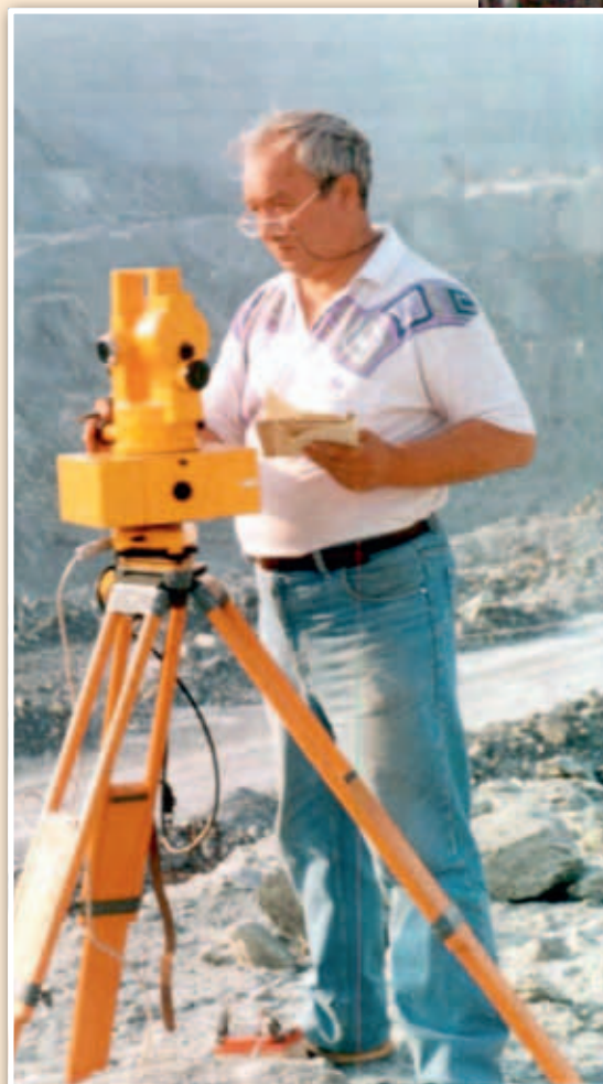
Маркшейдер С.Ф.Кузнецов работает со светодальномером. 1989 г.
