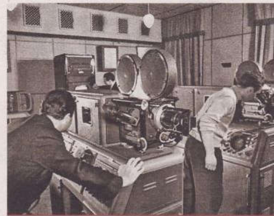
Телевизионная аппаратура, при помощи которой было получено изображение обратной стороны Луны
