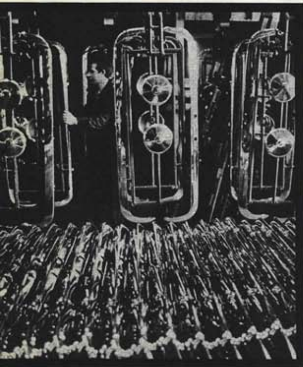
СЛОЖНЫЙ ПРОЦЕСС ГАЛЬВАНОПОКРЫТИЯ ДЕТАЛЕЙ ДОВЕРЕН АВТОМАТАМ.
