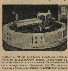
Динамо «Красного Октября» торфяной электростанции Ленинградского района, 4 лобовых динамо мощностью в 11 000 вольт доставляет шведским генеральным объектам для Волховстрой. Внутрии завод динамо может поместиться паровоз.
