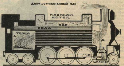
СЛЕВА: АМЕРИКАНСКИЙ ЭКСПРЕСС (скорый поезд) Чикаго-Нью-Йорк. СПРАВА: СХЕМА УСТРОЙСТВА ПАРОВОЗА: вода в котле, нагревая топкой А, превращается в пар, который собирается в верхней части локомотива, и за счет по трубе Д идет в золотниковую коробку Е. Коробка распределяет пар в цилиндры, заставляя его двигать поршень и соединенный с ним козлун Ж и шатуны З, вращающие колеса.
