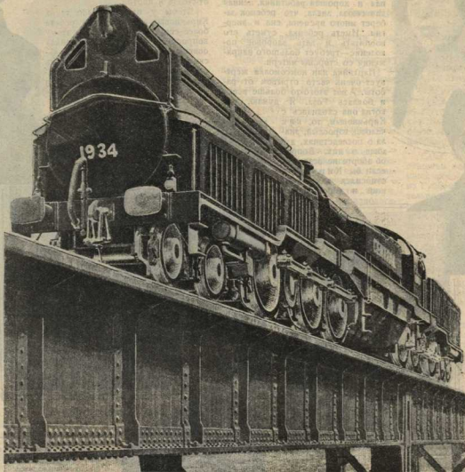
Новый турбовоз, строющийся в Америке (проект).
