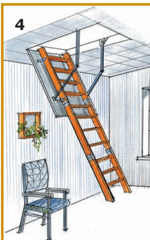
Общий вид складной лестницы на чердак
