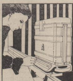
«Симаком» — так называется необычное транспортное средство на одной из почт ФРГ. Контейнер приводится в движение электродвигателем. Грузоподъёмность его — 8 килограммов. Сотрудница, обслуживающая «Симаком», с помощью кодированных сигналов указывает место доставки груза, и контейнер через несколько десятков секунд доставляет груз на любой из восьми этажей почтамта.
