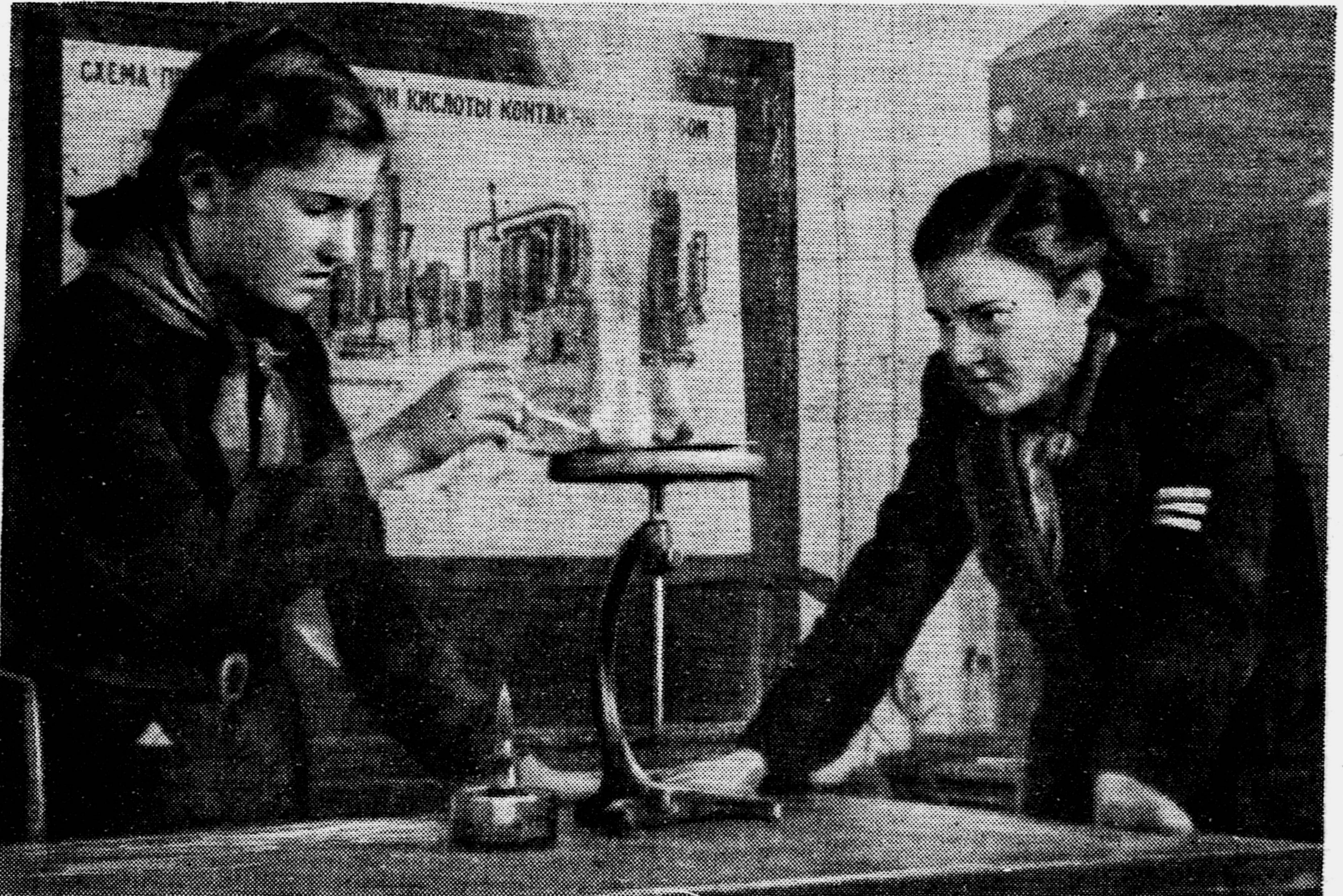
Лучше всего запомнится химическая формула, когда проверишь её на опыте. Ученица 610-й московской школы ИРА ЗАРАДЗИНСКАЯ подносит горящую лучинку к смеси серы с цинком. Смесь вспыхивает, в воздух летят светящиеся брызги. Вот и бенгальский огонь! Фото X. АМАСПЮР.
