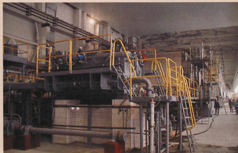
Бумажноделательная машина на 92% работает на оборотной воде, что соответствует европейским экологическим стандартам
