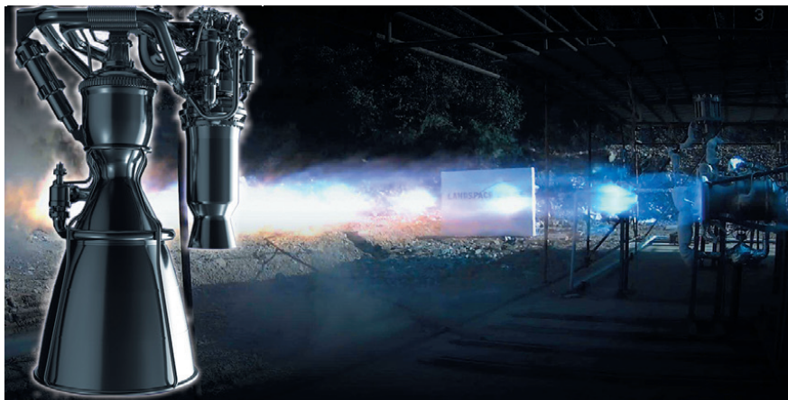
▲ Испытания кислородно-метанового двигателя TQ-12, 27 сентября 2018 г.
