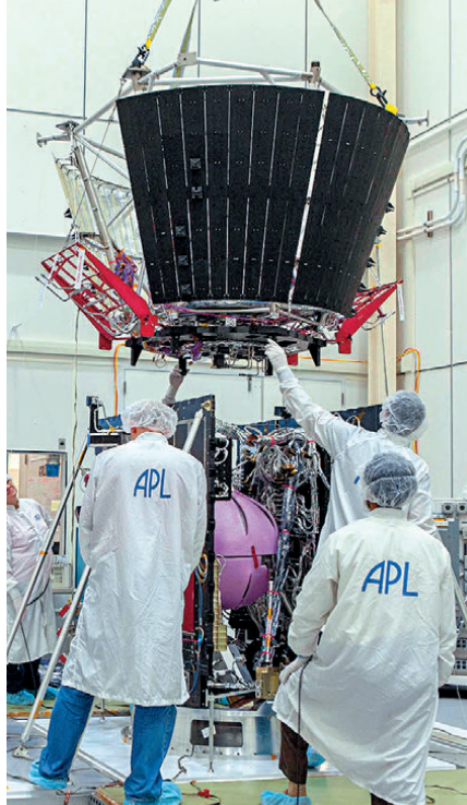
▲ Ферма с радиаторами системы охлаждения
