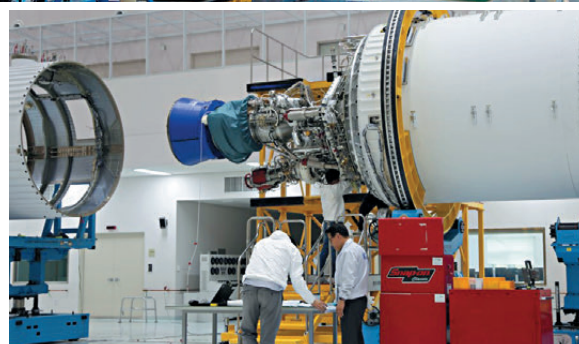
▲ Сборка демонстратора первой ступени KSLV-II в МИКЕ ракет-носителей на космодроме Наро
