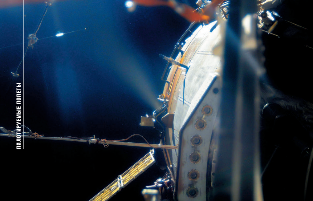
▲ Работа двигателей при коррекции орбиты МКС
