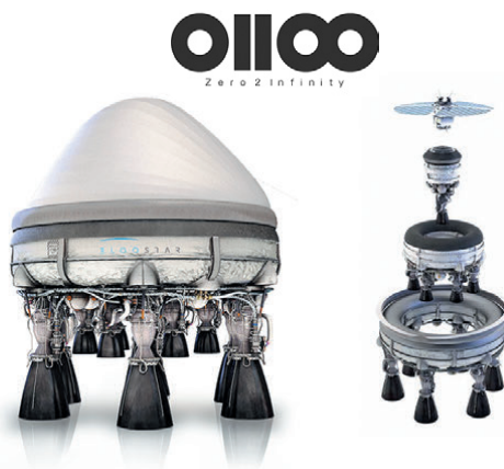
▼ Концепция трехступенчатого носителя Bloostar с аэростатным стартом
