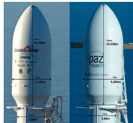
Табл. 2. Геометрические характеристики головных обтекателей Falcon 9 FT
