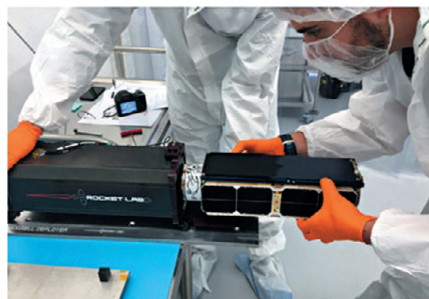
▲ Спутник Dove Pioneer устанавливается в диспенсер Maxwell
