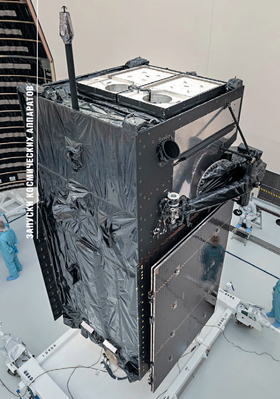
▲ SBIRS GEO 4 перед накаткой обтекателя и его силовой каркас на заводе Lockheed Martin
