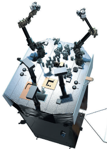
▲ Рабочие инструменты аппарата Restore-L (манипуляторы, сменные насадки, стыковочные держатели, датчики)
