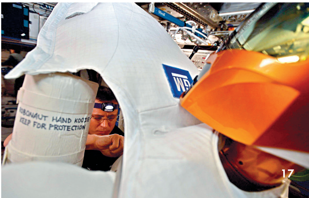
▼ Роботы тоже ломаются – Джек Фишер ремонтирует «Робонавта»
