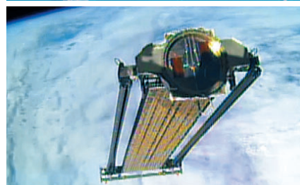
▲ Развертывание экспериментальной солнечной батареи ROSA (вверху) и она же в свободном полете
