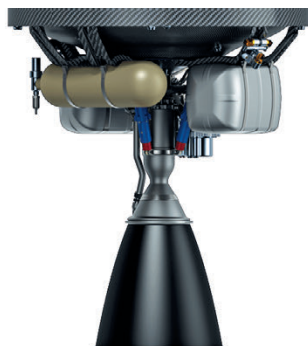
▲ Вторая ступень «Электрона» и двигатель «Резерфорд» с высотным соплом и «батареями» для насосов
