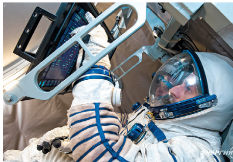
▲ На эргономическом макете космонавты и специалисты добиваются оптимальной компоновки панелей приборов и органов управления нового корабля
