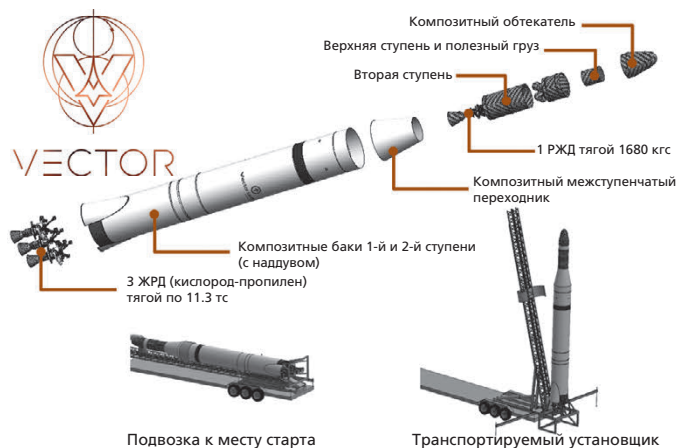
▲ Конструкция ракеты Vector-R и элементы наземного комплекса
