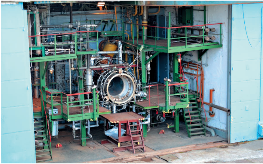
▲ Кислородно-метановый двигатель С5.86.1000-0 №2 на стенде 5В ИС-105 ФКП «НИЦ РКП»
