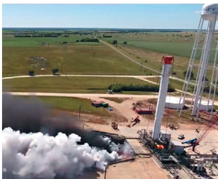
▲ Огневые статические испытания центрального блока (1033.1) FH Falcon Heavy 9 мая
