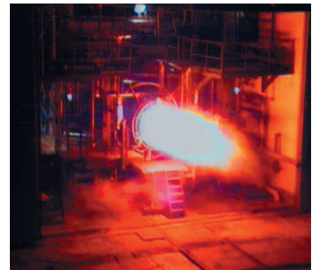
▲ Огневое испытание кислородно-метанового двигателя С5.86.1000-0 №2
