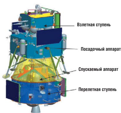
▲ Конструкция аппарата «Чаньэ-5»
