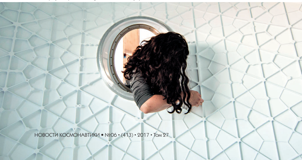
▼ Корпус корабля Dragon V2, вид изнутри
