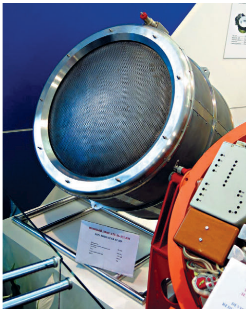
▲ Ионный двигатель высокой мощности (ИД-ВМ) обеспечивает тягу в 725 мН при удельном импульсе 7000 сек
