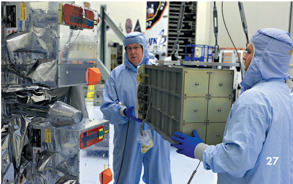
▼ Диспенсер для кубсатов на внешней поверхности грузового корабля
