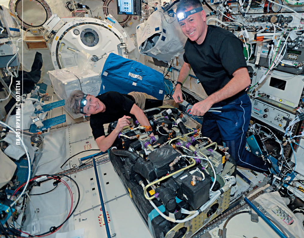
▲ Ремонт системы удаления углекислого газа CDRA
