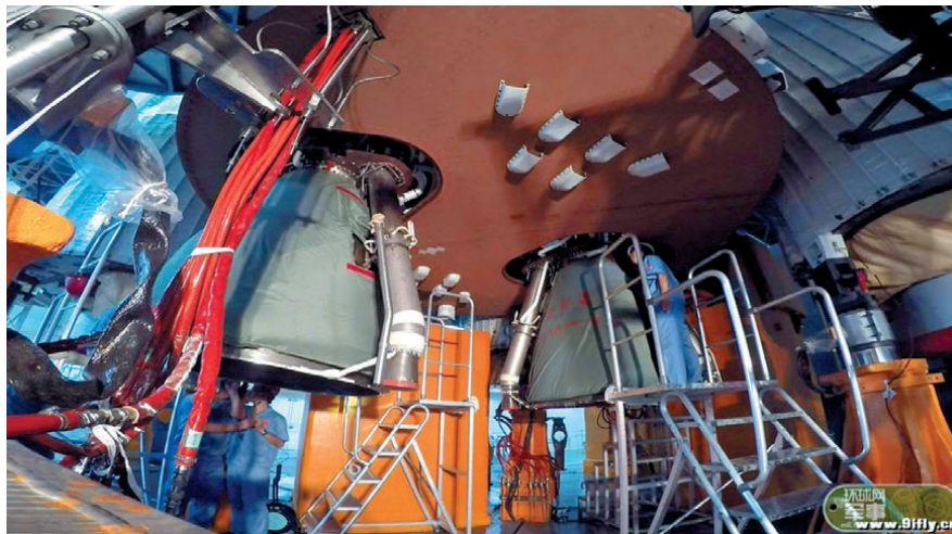
▲ Вид на донную часть центрального блока CZ-5 с установленными двигателями YF-77
