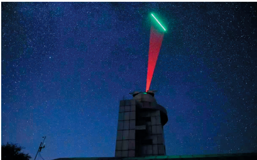
▲ Эпизод августовских испытаний. Наземная станция Синлун работает по спутнику красным лазерным маяком с длиной волны 671 нм, КА отвечает зеленым лазерным маяком с длиной волны 532 нм
