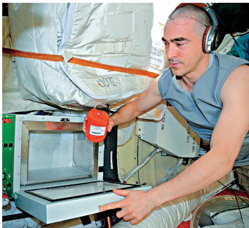
▼ Анатолий в перчаточном ящике заправляет биореактор эксперимента «Каскад» посевной культурой, затем помещает биореактор в термостат
