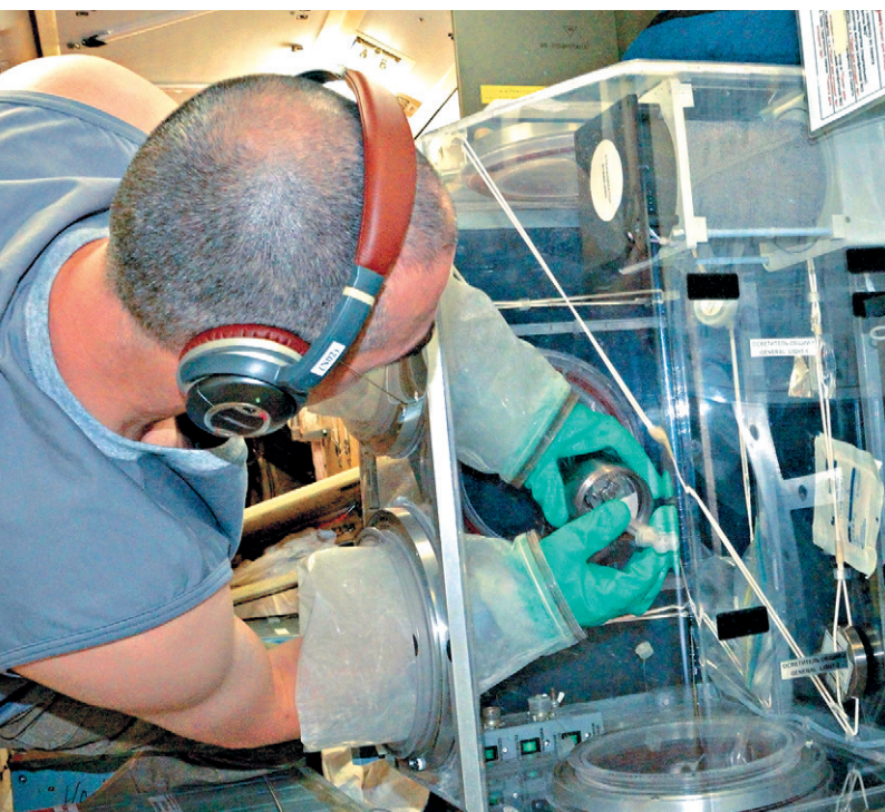
▼ Анатолий в перчаточном ящике заправляет биореактор эксперимента «Каскад» посевной культурой, затем помещает биореактор в термостат
