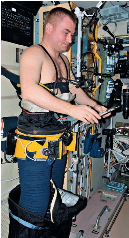
▲ Тренировки по предстоящему спуску на Землю проводятся в вакуумном костюме «Чибис-М». Справа – костюм без тренирующегося
