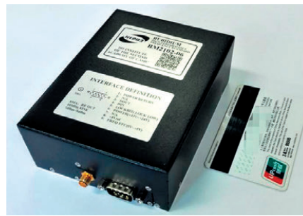
▲ Бортовой стандарт частоты для навигационных спутников «Бэйдоу»
