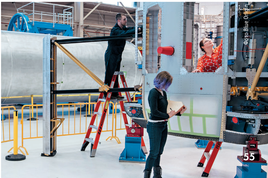
▼ Сборка хвостового отсека системы New Shepard на заводе Blue Origin
