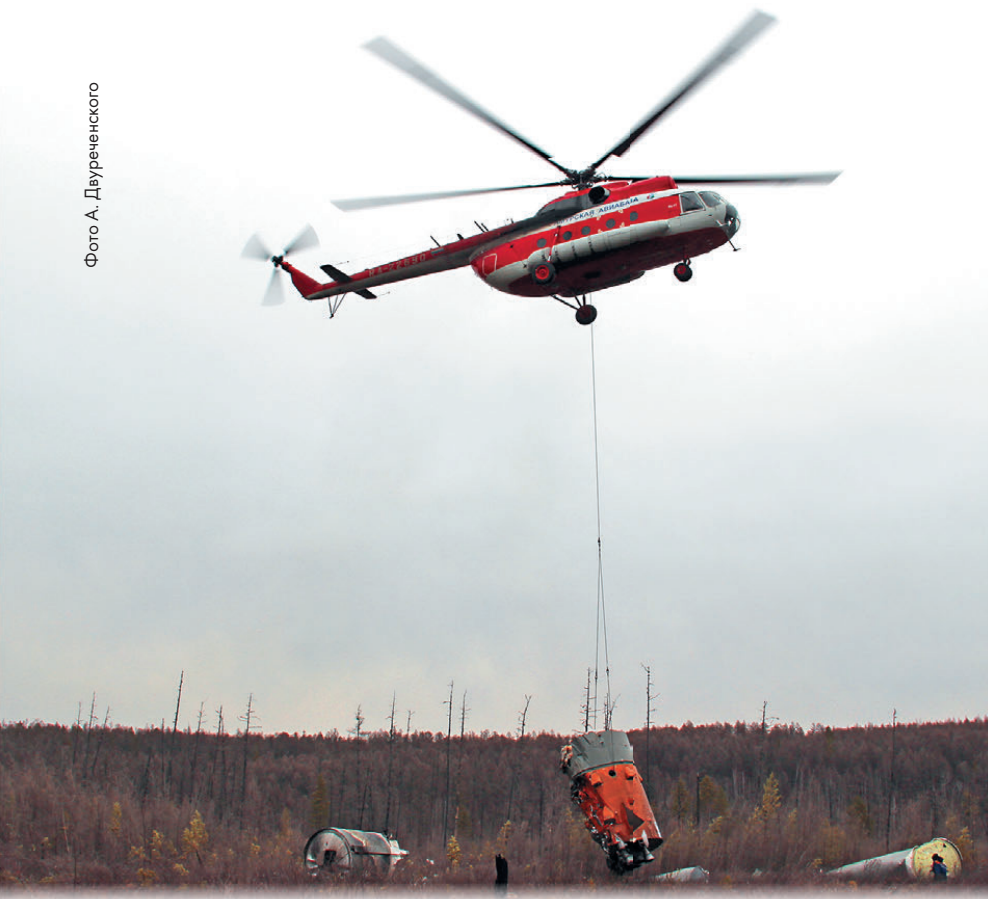
▲ Вывоз фрагмента бокового блока из РП №981 на внешней подвеске вертолета Ми-8
