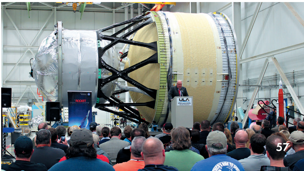
▼ Ступень ICPSS, которая будет использоваться в первом пуске SLS Block 1
