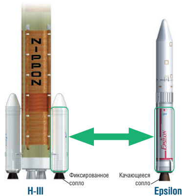
▲ Новые твердотопливные ускорители будут максимально унифицированы с первой ступенью ракеты Epsilon
