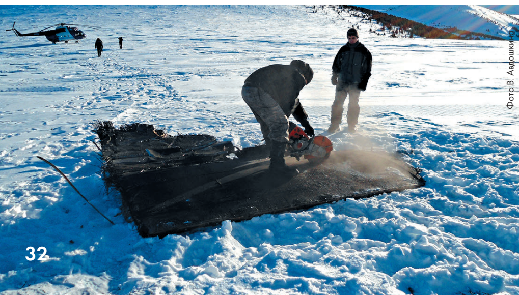
▼ Найденный фрагмент нижней створки головного обтекателя РН «Протон-М» пуска 30 января в районе падения №327
