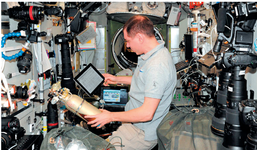
▲ Сергей Волков прокомментировал эту фотографию на своей странице в соцсети «ВКонтакте»: «У меня в руках кислородный баллон, сверяю его номер с номером, указанным в радиограмме. В скафандр устанавливаются два таких баллона – основной и резервный»
