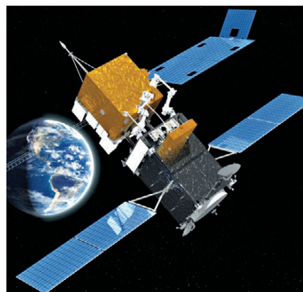
▲ Аппарат RESTORE-L планируется использовать для дозаправки низкоорбитального КА Landsat 7
