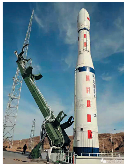
▲ Фото слева показывает вертикализацию и установку ракеты CZ-6 на стартовый стол с помощью стационарного установщика. Фото справа демонстрирует работу наземного оборудования после отмены старта 19 сентября: стрела установщика подводится к ракете, стоящей на стартовом столе
