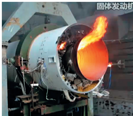
▲ Огневые испытания РДТТ первой ступени
