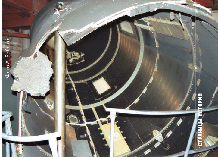
▲ Повреждения головного обтекателя, полученные при проведении испытаний 22 декабря 1999 г.
