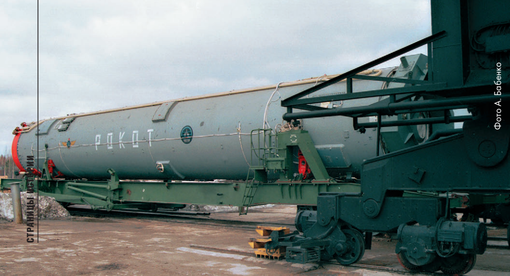
▲ ТПК с блоком ускорителей перед установкой на старт, весна 2000 г.
