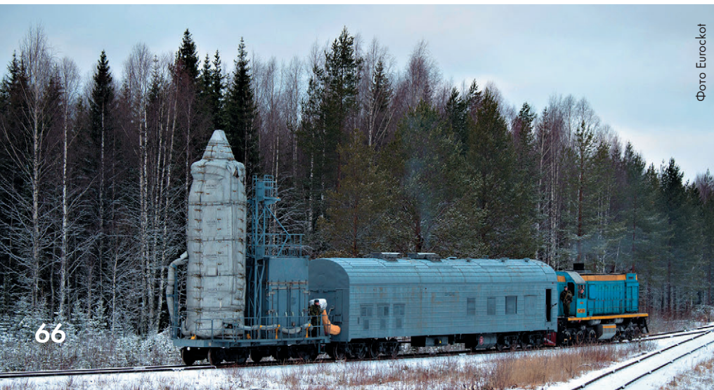
▼ Транспортировку КГЧ на старт осуществлял состав из тепловоза, вагона термостатирования и транспортного агрегата
