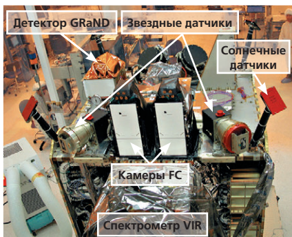
▲ Расположение научной аппаратуры КА Dawn
