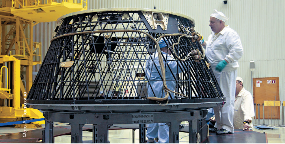
▲ Переходной адаптер для спутника производства Центра Хруничева
