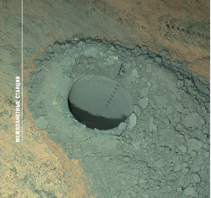
▲ Две попытки получить образец для анализа: успешная (Windjana, 621-й сол) и неудачная (Bonanza King, 724-й сол)
