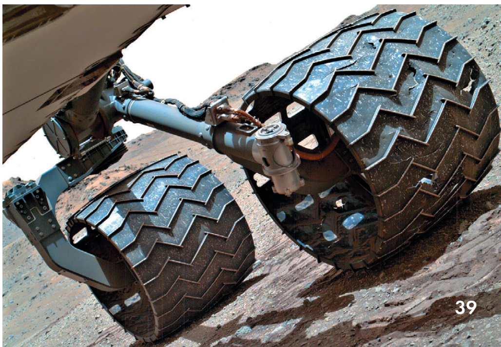
▼ На этом снимке, сделанном 21 апреля 2015 г., в 962-й сол, видны многочисленные повреждения ободов ходовых колес марсохода Curiosity
