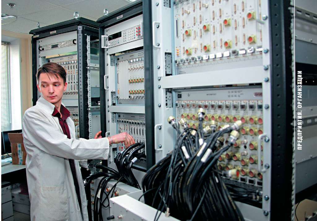
▲ Система измерительная автоматизированная функционального контроля ТЕСТ-2904-03, предназначенная для имитации интерфейсов вычислительного комплекса
